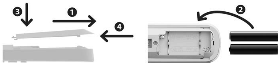
Figure 2 : Insertion des piles
