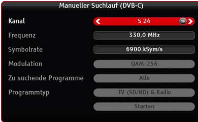
Abbildung 59 Programmsuche: Manueller Programmsuchlauf - DVB-C
